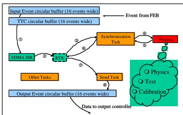
Figure 5 : The DSP code structure
