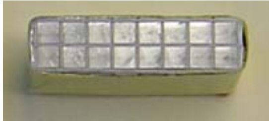
Photo 3 : Bloc de 16 cristaux placés dans un panier de tyvek/aluminium.
