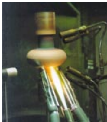
FIG. II.4 – Réalisation de revêtement par projection thermique
