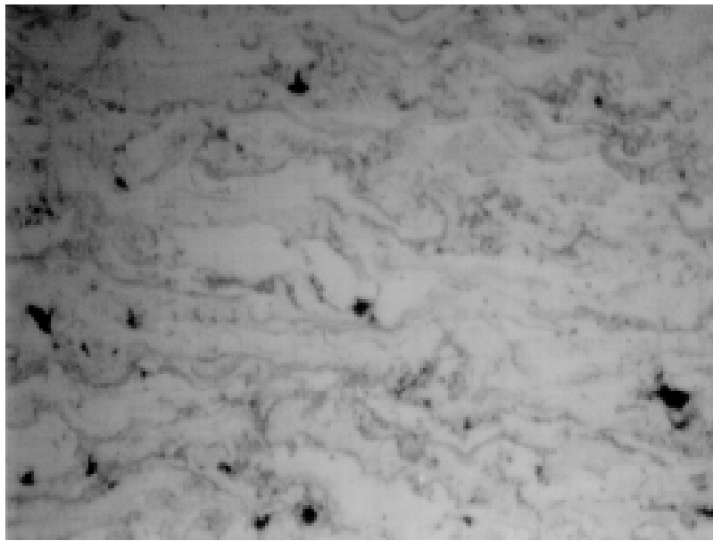
FIG. I.3 – Observation microscopique d'un dépôt de cuivre HVOF
