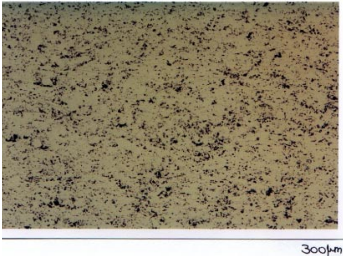
FIG. I.5 – Observation microscopique d’un dépôt de cuivre IPS
