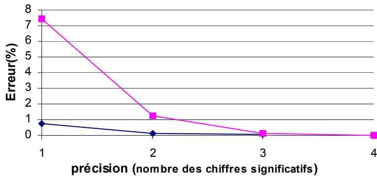
Figure VI-4 : Erreur en fonction de la précision numérique (trois mesures, faisceau non rond)
