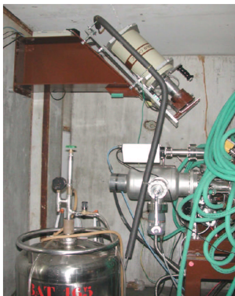
Figure 1: Installation du détecteur à jonction germanium "Béatrice" auprès de la maquette de DTL du projet IPHI.
