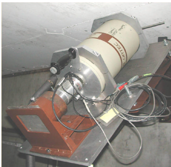
Figure 1: Installation du détecteur à jonction germanium "Béatrice" auprès de la maquette de DTL du projet IPHI.
