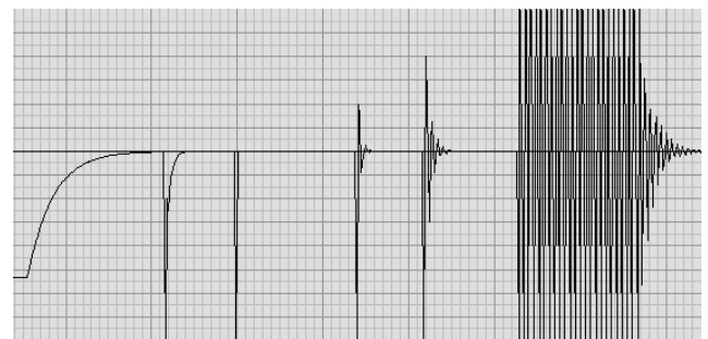
Figure 3. Régimes traversés pendant l'ajustement du gain intégral
