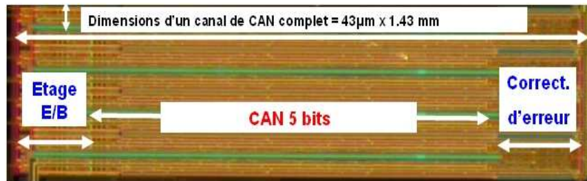
Figure 4. Layout d'un prototype avec 8 canaux de convertisseurs
