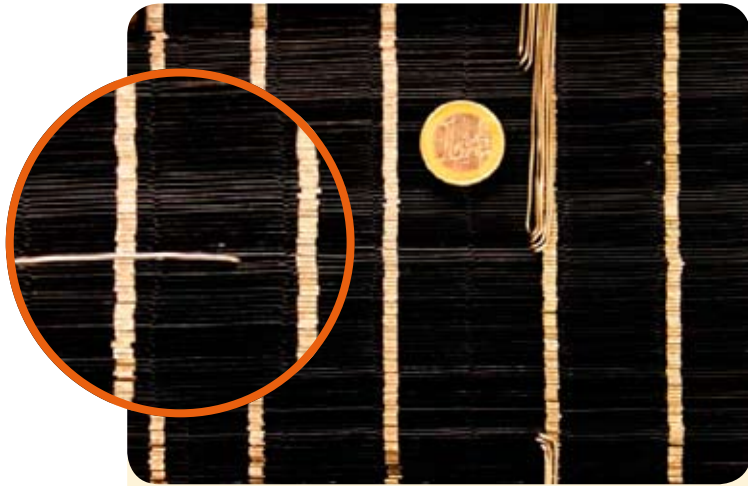
Empilement de plaques planes utilisé dans un système thermoacoustique.
