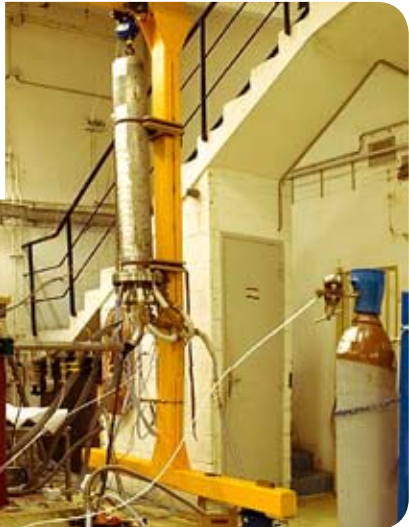
◀ Générateur thermoacoustique d'onde de l'IPN en cours de montage et installé au bâtiment 109. Banc d'amplification thermoacoustique d'onde au bâtiment 103.
