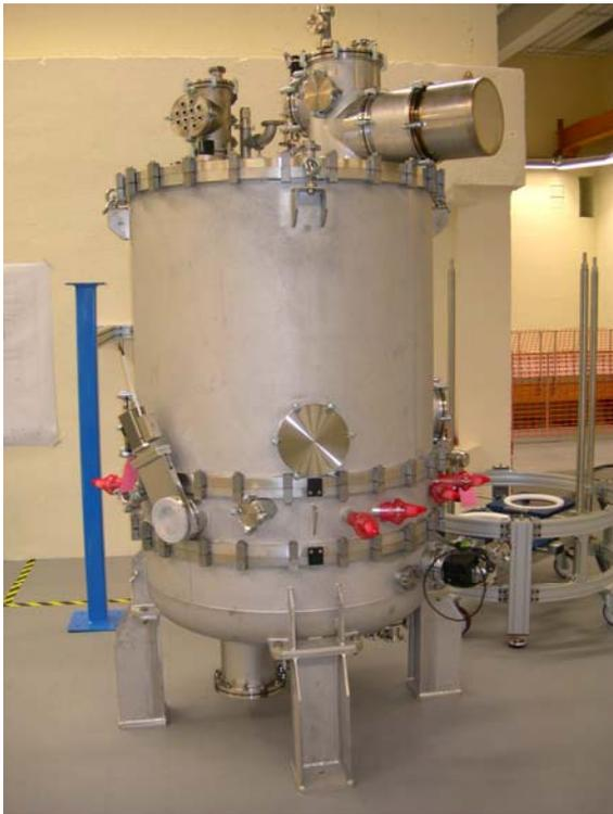
Figure 12(b) : The first  $\beta$  0.12 Cryomodule
