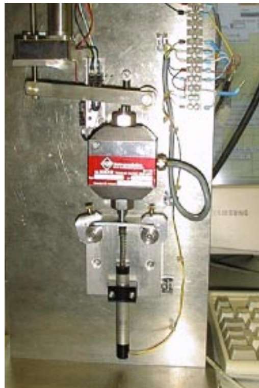
FIG. II.8 – Mesure de flexion à trois points
