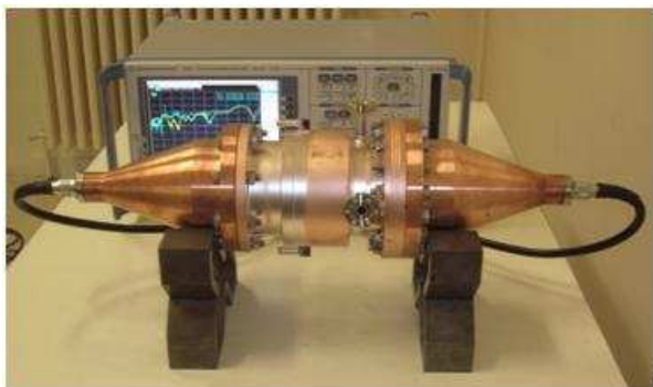
FIG. 1.8 – Mesure des paramètres RF du bloc fenêtre.
