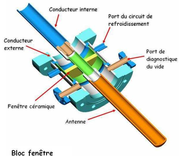
FIG. 1.7 – Schéma du coupleur de puissance.
