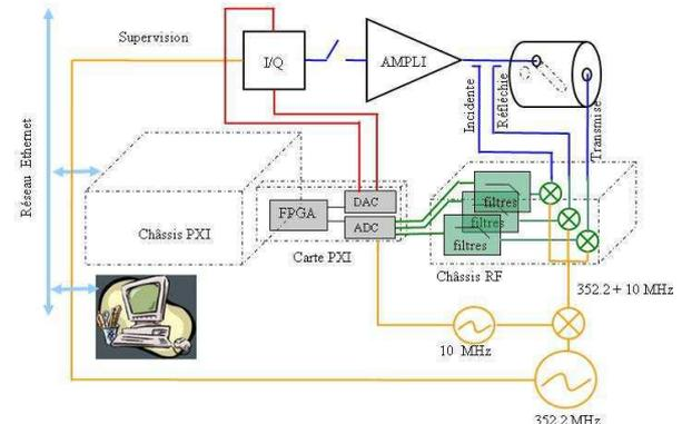
FIG. 1.5 – Système de contrôle et commande LLLRF.
