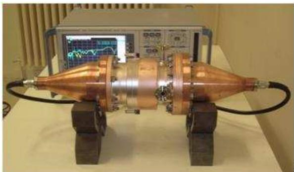
FIG. 1.8 – Mesure des paramètres RF du bloc fenêtre.
