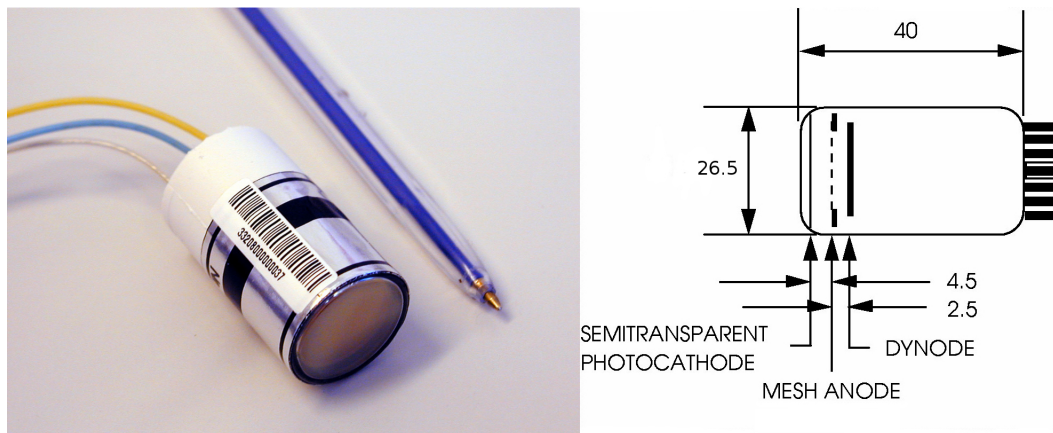
FIGURE 3.8 – Photographie et schéma d'une phototriode à vide utilisée dans les bouchons du ECAL [59].
