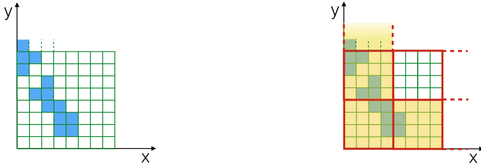
FIGURE 3.6 – Vision schématique d’une trace 2D enregistrée sur des pixels (verts) à gauche. Les pixels de base sont regroupés en pixels plus large de taille fixe (rouges) à droite. Les quatre pixels larges sont regroupés plus rapidement et la rupture entre pixels initiaux est lissée. L’information des pixels de base est ensuite utilisée par zone pour définir les traces.
