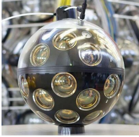
Figure 1: Une photographie d'un DOM complet, dans la galerie d'assemblage du CPPM (extrait de Réf [1]).
