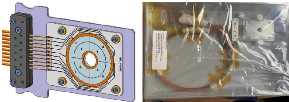
Figure 75: schéma d'un des 2 détecteurs Si annulaire et de son support (à gauche), et ensemble monté avec les câbles et délivré par Micron (à droite). Le diamètre extérieur du détecteur est de 40 mm, le diamètre interne de 12 mm.
